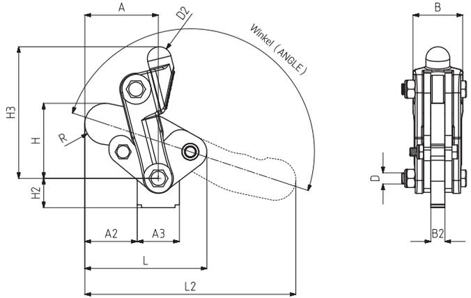
**Befestigungsart: vertikal mit beweglichem Fuß**
